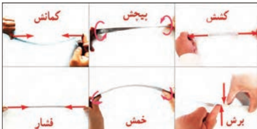
شکل ۴- انواع بارگذاری روی خط کش فلزی
