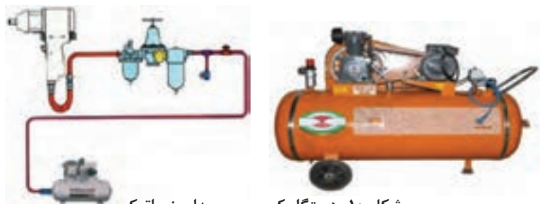
شکل ۱۰- دستگاه کمپرسور و مدار پنوماتیک
