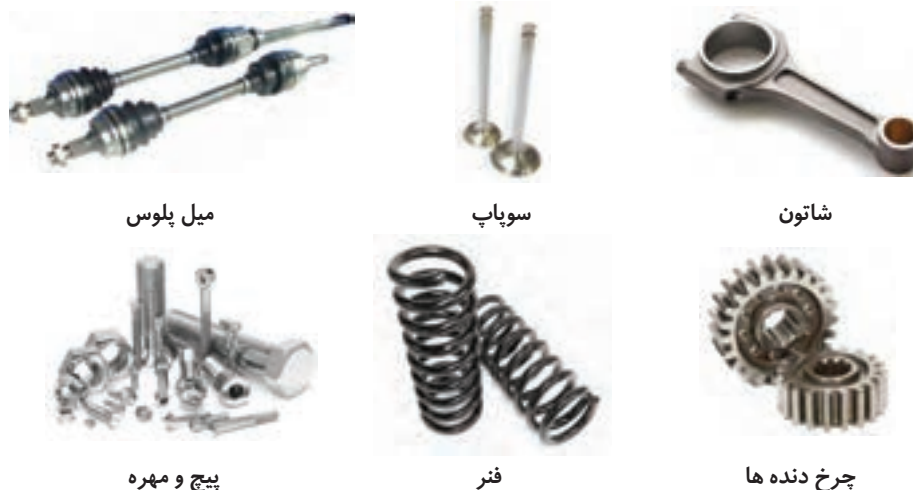
شکل ۱۸- کاربرد فولاد آلیاژی در قطعات خودرو
