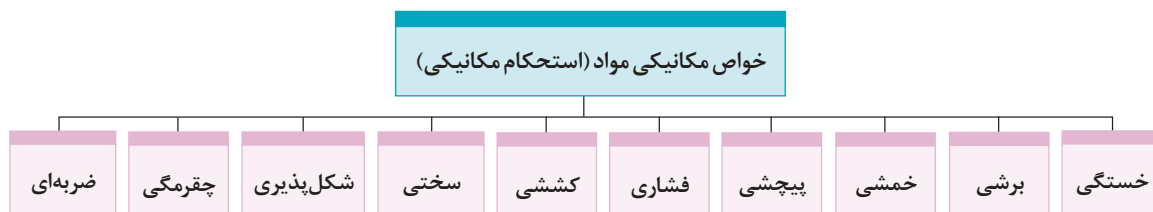
شکل ۹- نمونه‌هایی از خواص مکانیکی مواد (استحکام مکانیکی)
