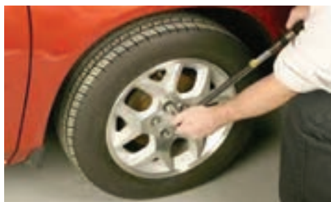
شکل ۴- گشتاور لازم برای سفت کردن چرخ
